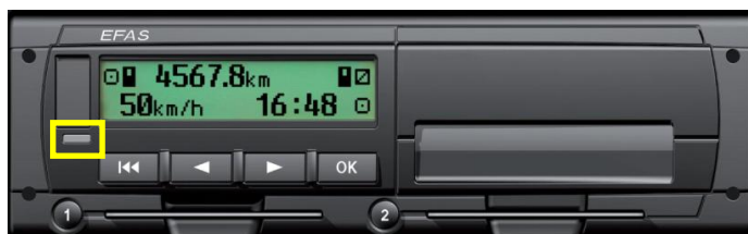
Рисунок 4. Красный LED для индикации рабочего режима
